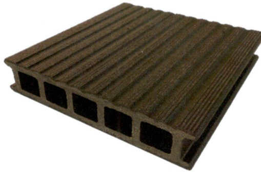
Foto 1. UCM firmasının laboratuvarında teste tabi tutulan ko-ekstrüzyon ahşap plastik kompozit numunesi
